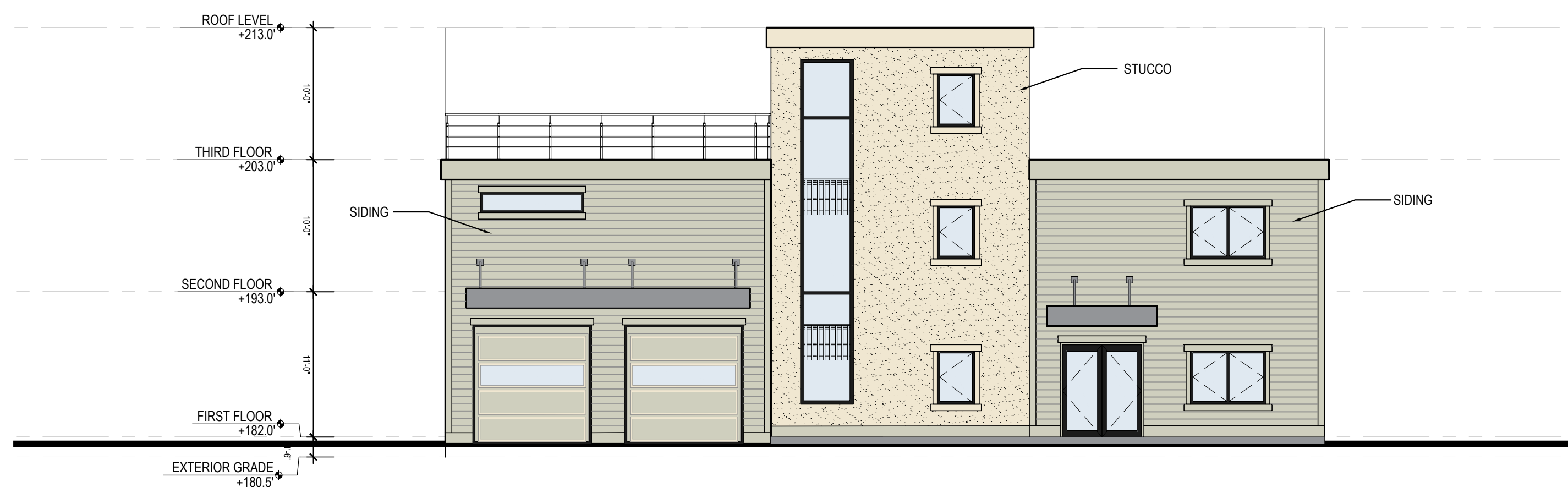
1 EAST ELEVATION A400 SCALE: 1/8" = 1'-0"
